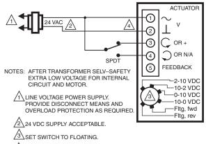
4 ENSURE PROPER GROUNDING OF ACTUATOR CASE. M35122
