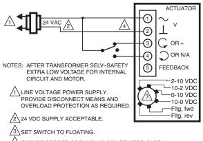
4 ENSURE PROPER GROUNDING OF ACTUATOR CASE. M35125
